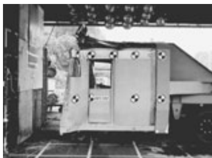
図3 模型構体の衝突実験
