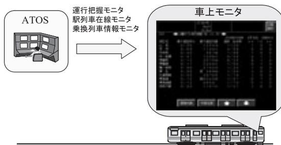
図8 車掌用ATOS情報システムの概要
