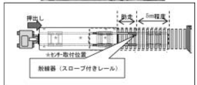
図3：脱線試験概要図
