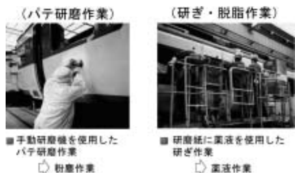
図2：塗装下地作業の現状
