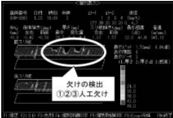
図24：人工欠けの検出（3D画面）
