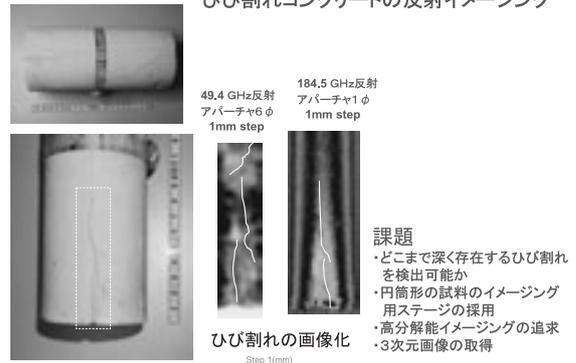
高い周波数を使うと表面付近のひび割れに関してかなり色々なものが見えてきます。その例を次の図に示します。低い周波数では表面から観察されない深い位置のひび割れがわかるのですが、高い周波数では表面からは観察できない表面付近のひび割れが見えることがわかります。
