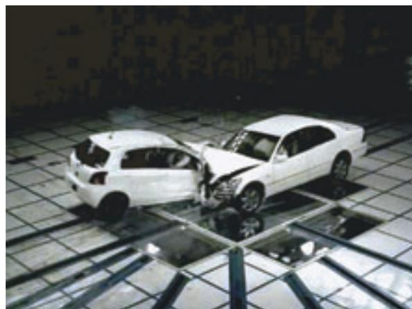
写真1 Car to Car オフセット衝突試験
