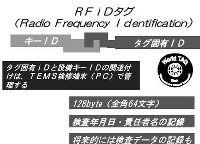
図6 RFIDタグの概要
