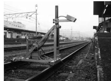
図5 新型レーザ式ホーム限界測定装置の試作機
