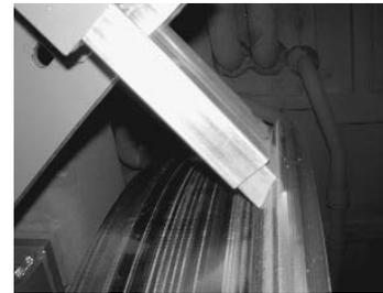
図4 車輪用潤滑剤の塗布装置 (フランジ接触状況)
