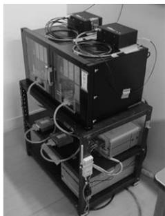
図8 試作したウィンド型故障選択装置の写真
