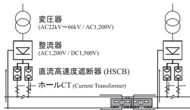
図1 直流き電システム
