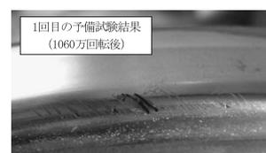
図7 はく離傷を生じたレール試験片
