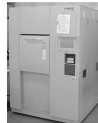
図5 冷熱衝撃試験機
