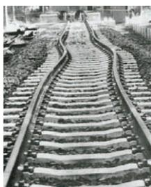
図1 座屈したレール（再現試験）
