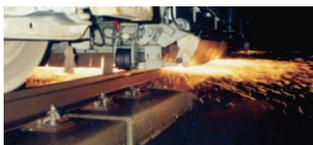
図8 レール削正車によるレール削正の様子
