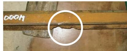
図5 レール底端部での電食
