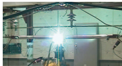
図3 カテナリ式剛体架線でのアーク試験
