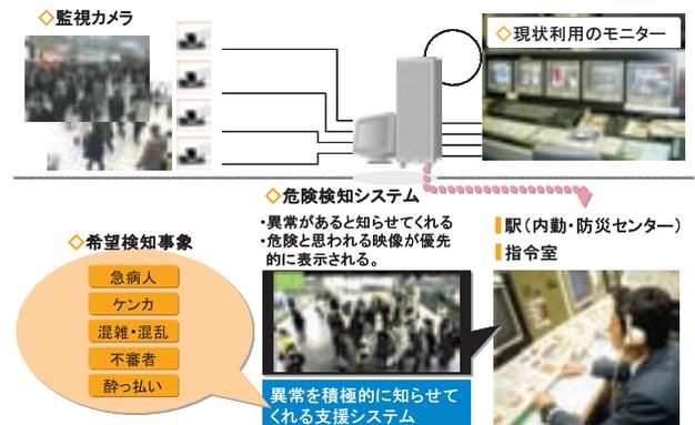
図7 監視画面を用いた危険検知システム
