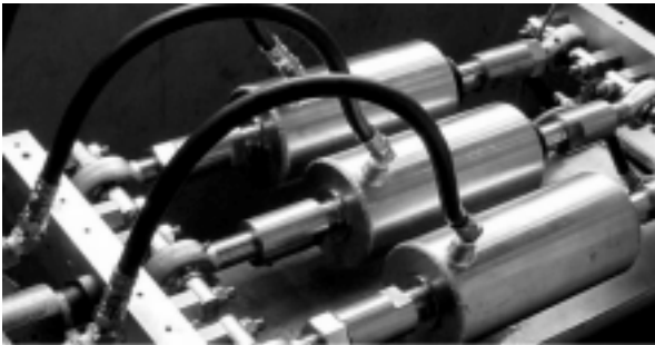
図3 オイルダンパ定置耐久試験
