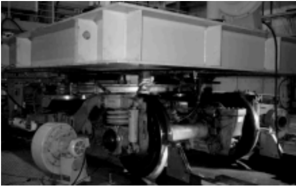
図2 開発台車の試験台試験（台車試験装置）
