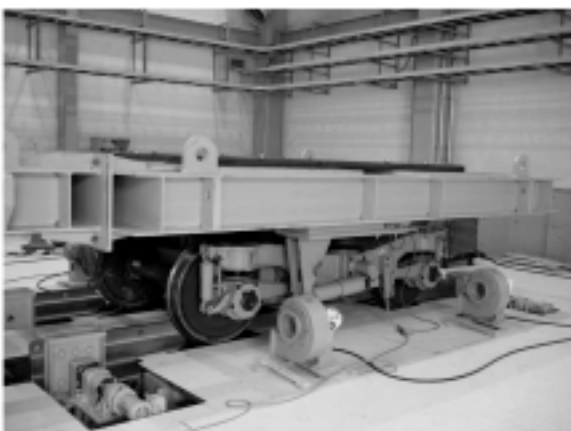
図10 長期耐久試験（台車試験装置）
