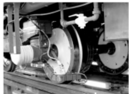
図8 電車区構内走行試験でのPQ測定
