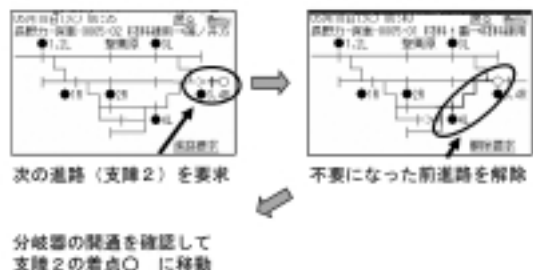
図6 尺取虫方式による保守用車進路構成
