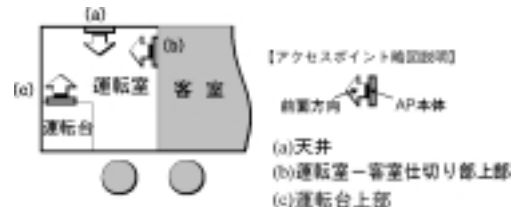
図6 設置位置確認試験
