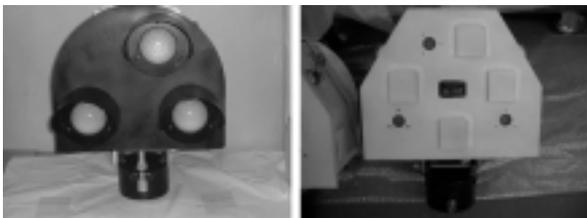
図6 入換信号機（前面、背面）
