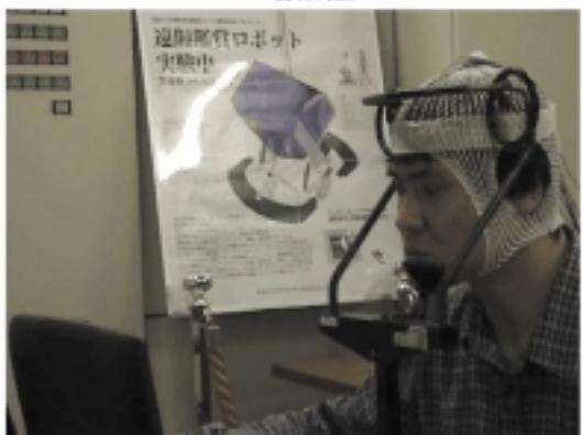
こちらは、寝たきりの老人が病床の中で遠隔操作が簡単にできるものです。頭にネットを張って脳波を測定していますが、絵を見たときにどのように反応するのかを調べているわけです。人間が絵画にどう感動するのか、どの時点で感動しているのか、データとして取得するためには、このようなロボットを作り出して遠隔鑑賞の操作データから類推せざるをえないということが私たちの結論でした。現在では、光トポグラフィとか、頭に血がどれだけどこに集中するかということを測定するような技術も非
