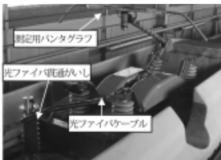
図7：光ファイバセンサによる接触力測定現車試験
