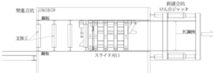
図12：掘削・支保工建込み
