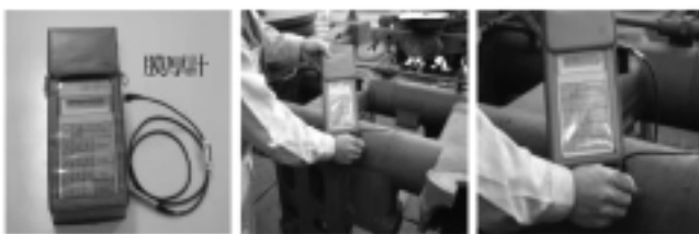
図8：台車枠での塗装厚さの測定
