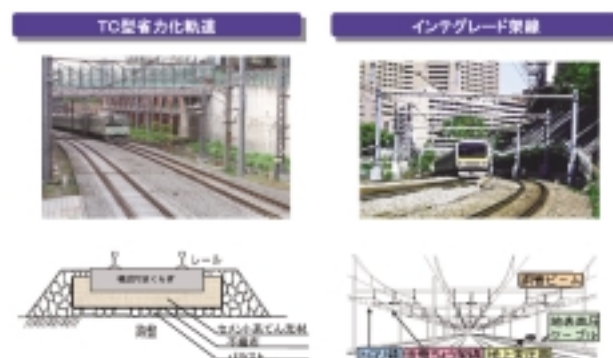
図6：TC型省力化軌道とインテグレート架線
