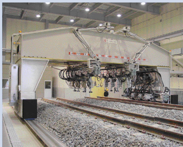
図4：実物大軌道試験装置
