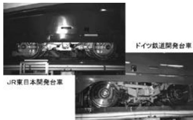
図10：開発台車のE2系車両取付け
