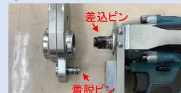
差込ピンと着脱ピンによる2点支持
