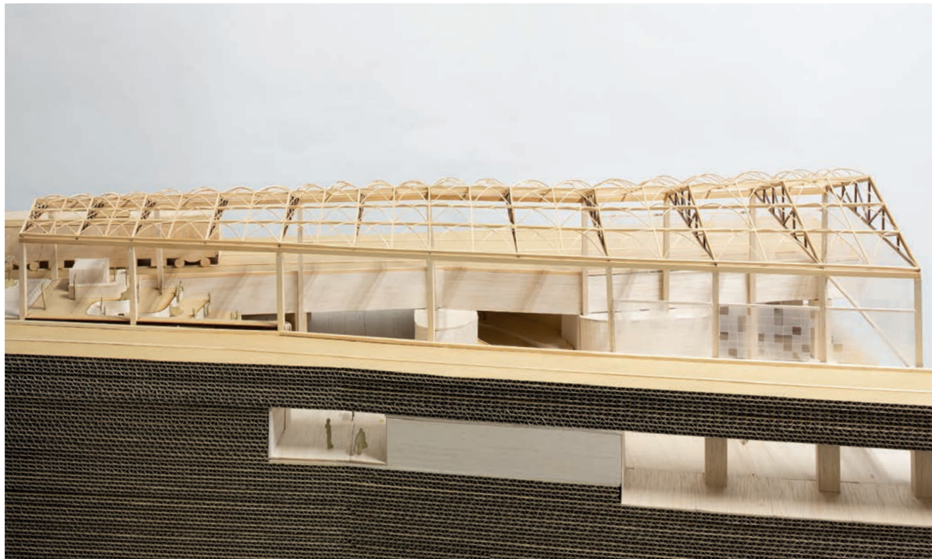
屋根を高架より高い位置に持ち上げること自然光と屋上庭園へのアクセスを確保する。 Positioning the roof structure above the train track increases the visibility with natural light as well as accessibility towards the rooftop garden.
