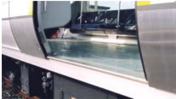
外吊扉による扉下レールの段差解消
