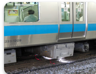
営業列車による 線路設備モニタリング
