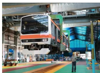
車体吊り上げ実演
