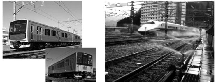
非電化区間の環境性能向上を実現する蓄電池駆動電車「ACCUM」(左上) 同試験車両「NE Trainスマート電池くん」(右下)
