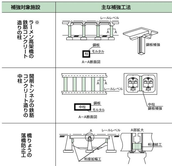
※ラーメン高架橋：ラーメンとはドイツ語で、結合構造の意。柱と梁(はり)を一体として結合した構造で、全体に力をバランスよく分担させる構造をラーメン構造といいます。この構造形式を用いた橋りょう形式をラーメン高架橋と称します。
