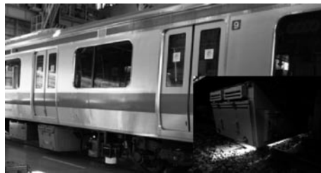
高頻度に線路状態の変化が把握可能な「線路設備モニタリング装置」
