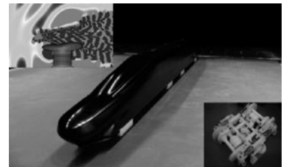
模型を使用した高速走行時における「トンネル 内の車両挙動解析」や「騒音発生メカニズム の解明」
