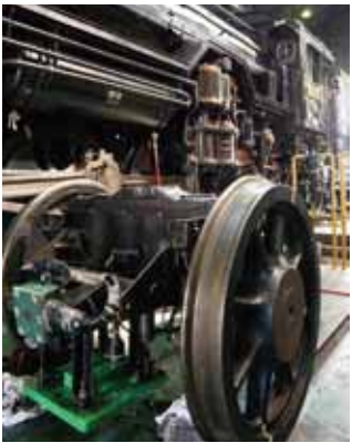
検査のため車輪を外しての作業
