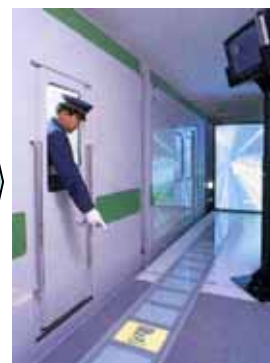
各支社の総合訓練センターに設置されている 事故予防型シミュレータ
