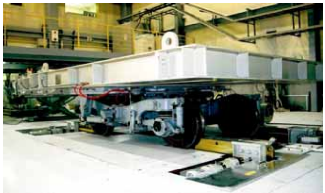
台車試験装置
