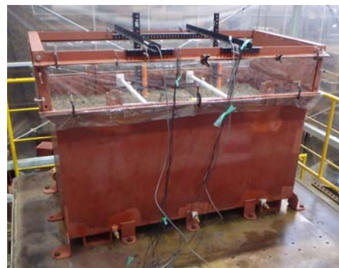
図2 小型模型による振動台実験
