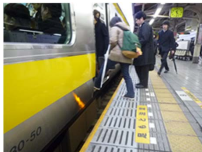
ホームと車両(扉)との隙間状況
