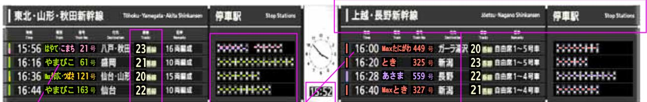
番線案内を強調(太字・色分け) 停車駅表示(液晶表示) デジタル時計の併設 印刷文字でなく、内部照明式文字
