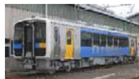
世界初のハイブリッド鉄道車両 (キハE200形気動車)
