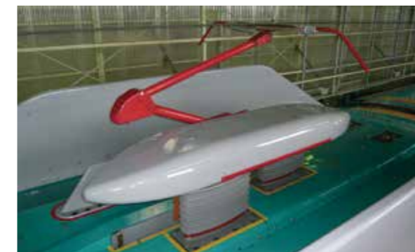
E5系では、低騒音型のパンタグラフを搭載
