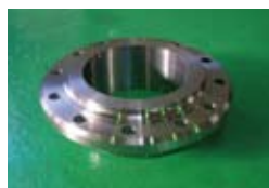
長野総合車両センター 廃車輪をブレーキディスクの部品にリサイクルしています
