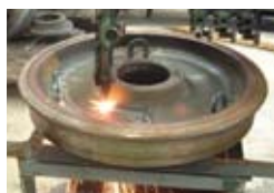
長野総合車両センター 廃車輪をブレーキディスクの部品にリサイクルしています
