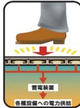
「床発電システム」の仕組み
