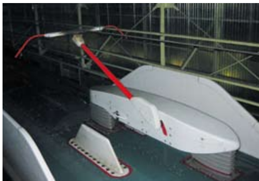
試験車両「FASTECH」では、低騒音型の一本主軸型パンタグラフを搭載
