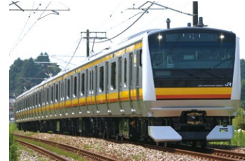
E233系 通勤・近郊での主力として活躍する VVVFインバータ車両
