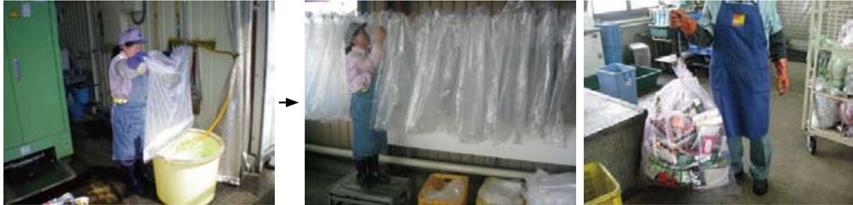
回収した使用済みのゴミ袋に穴がないかチェック後、洗浄し乾燥させて再利用
